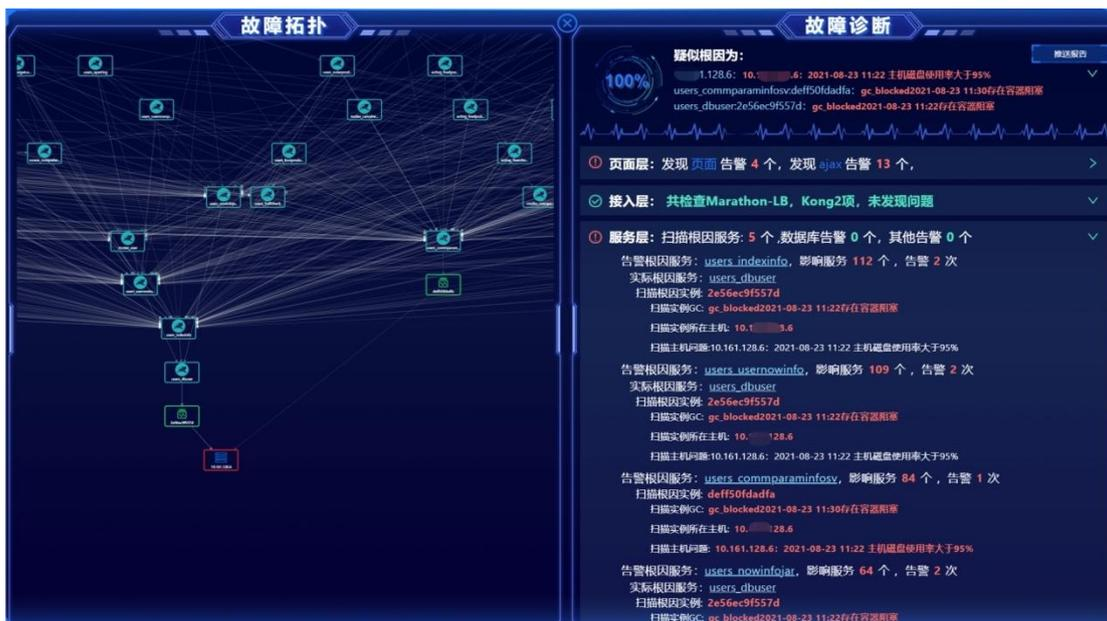
故障根因在外部接口案例：外部接口故障：除了自身系统内部的问题，还可能会遇到外部因素的干扰。例如，依赖的第三方接口出现了问题。这样的问题又该如何快速发现，快速感知，快速排查呢？
