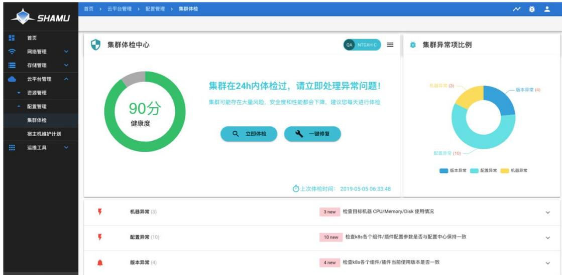
配置不一致是万恶之源，为了解决这一问题，携程云团队投入了大量精力确保所有系统配置的一致性。携程云团队开发了一款基础工具，专门用于监控和检测宿主机上的 Kubernetes 组件配置是否一致。检查项不仅包括各组件的配置，还涵盖了内核参数以及各服务的配置设置。
