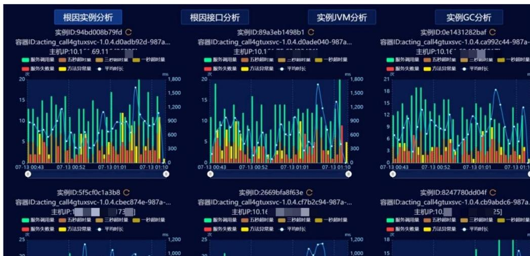
实例/接口分析：调用链与云化 CMDB 做关联，关联到容器与主机
