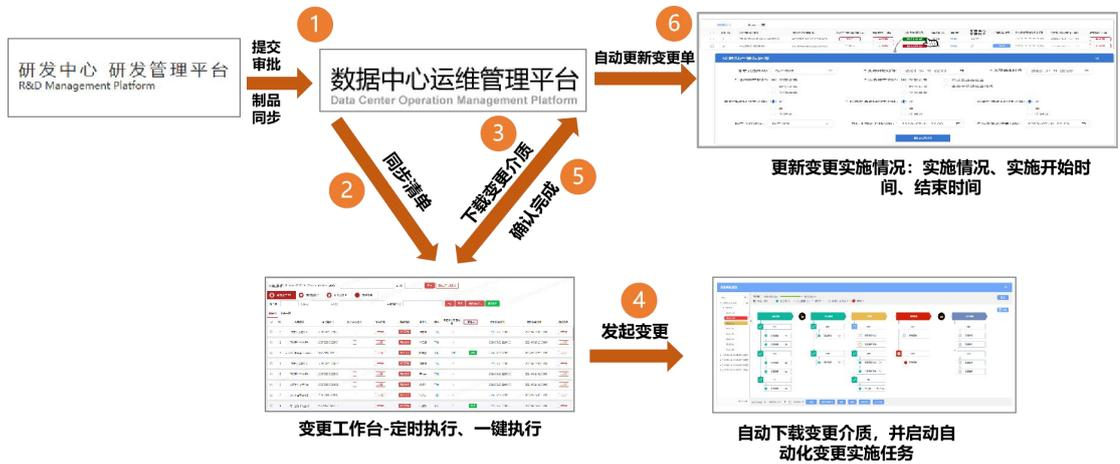
2) 生态对接实现变更执行自动化：应用变更执行过程由变更前检查、监控维护期设置、程序变更、配置变更、数据变更、技术检查等 6 个环节组成。
