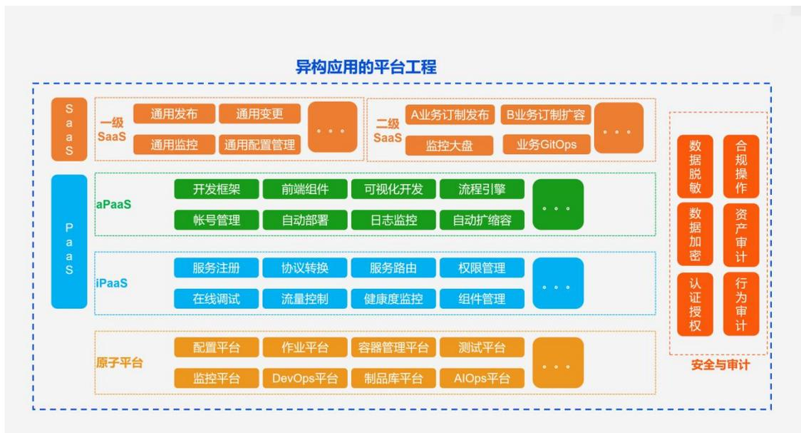
如图所示，面向异构应用的平台工程的总体结构可划分为 3 层，自下而上依次是：原子平台层、PaaS 层和 SaaS 层，其中 PaaS 层包括 aPaaS 和 iPaaS 两大核心能力，SaaS 根据场景分为一级 SaaS 和二级 SaaS。除此之外，平台工程本身也需要提供平台服务管理和安全审计的能力。
