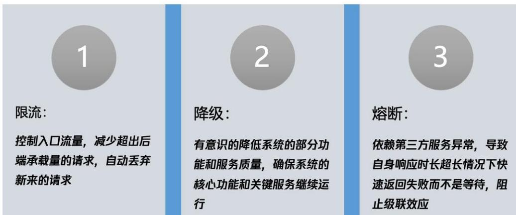
限流的目的是控制入口流量，减少超出后端承载能力的请求，并丢弃新请求。限流可以在不同层次上实现，例如在四层和七层网络协议上，或者在引擎层和数据库层上。通过限流，我们可以有效地防止系统过载，确保系统稳定运行。
