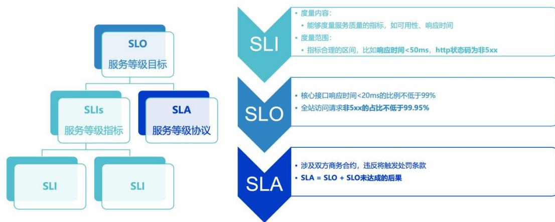
上述所提及的即为标准化的 SLIs/SLO/SLA 体系，该体系融入了 VALET 方法，通过五个核心维度——容量（V）、可用率（A）、延迟（L）、错误（E）、以及人工提单与保底分类（T）——来系统地梳理 SLI。这一步骤是构建系统可用性的基石，若无此体系，则无法有效地衡量系统可用性，后续的工作亦将缺乏坚实的基础。
