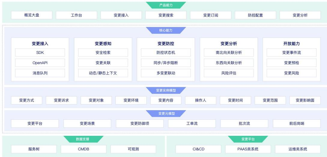
变更管控平台面向不同用户提供丰富的功能，包括面向研发和 SRE 的变更信息感知、检索和订阅，以及面向平台方提供的变更场景接入、托管等能力。以下是对每个功能的具体描述：
