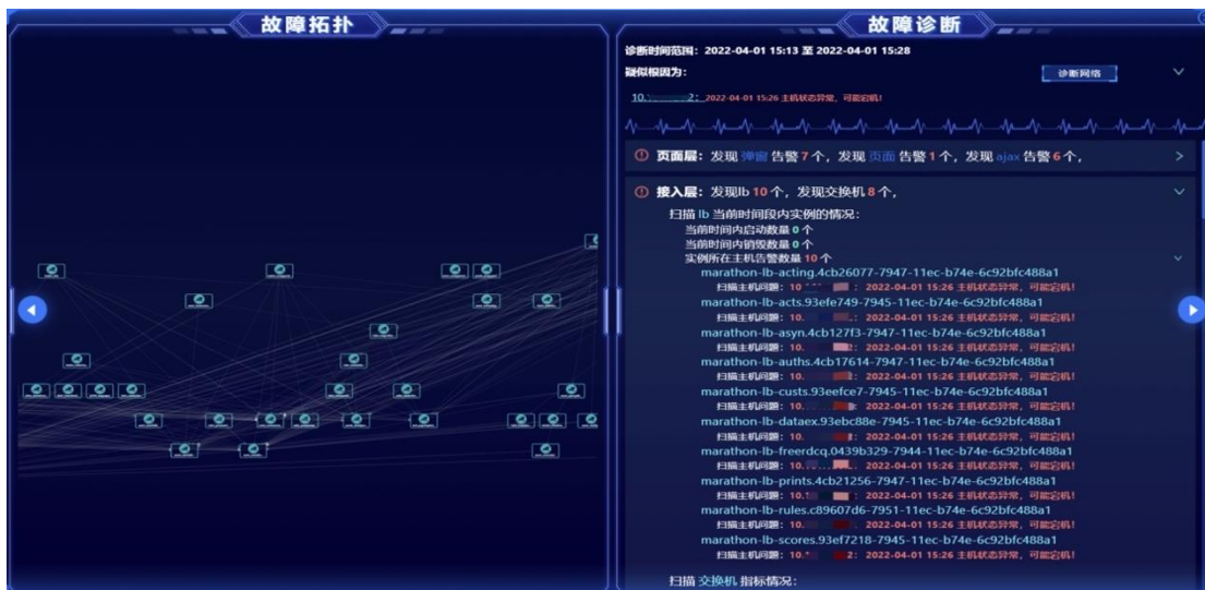
主机宕机异常: LB 所在主机宕机导致 lb 实例销毁重启服务波动
